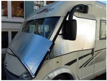
Die Frontmatte kann bei Bedarf von oben nach unten am Klett entlang abgeklappt werden.
