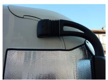
Oberer, durchgehender Gummizug der Frontmatte am Ende der Kedeleisten oder am Spiegel oben einhängen und gegebenenfalls Gummi nachspannen, sodass die Frontmatte oben gut und dicht anliegt.
