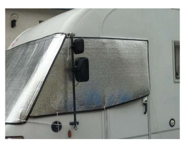
Seitenteile der Außenmatte in die Kederleisten einziehen. (Klett sichtbar)
