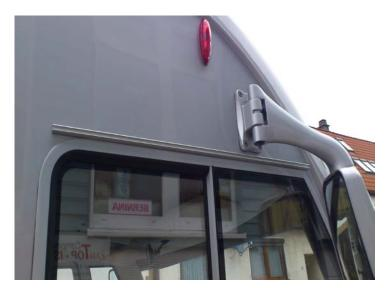
Kederschienen ca. 2 mm über Beifahrer- und Fahrerfenster bzw. Türrahmen kleben. Klebestellen vorher gut reinigen! Sikaflex 221i auf die Rückseite der Kederschienen auftragen und an die Fahrzeugwand andrücken. Klebestellen ca. 6 - 12 Stunden trocknen lasse
