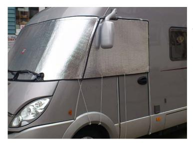
Abspanngummis der Seitenteile am Radlauf bzw. an der Karosserie einhängen.
